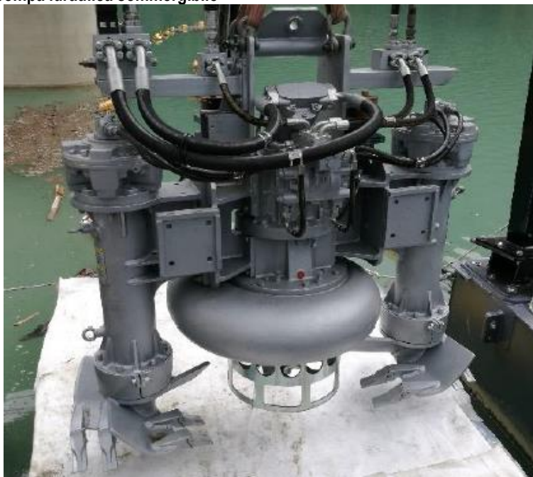
Figura 3-12: esempio di pompa idraulica sommergibile
