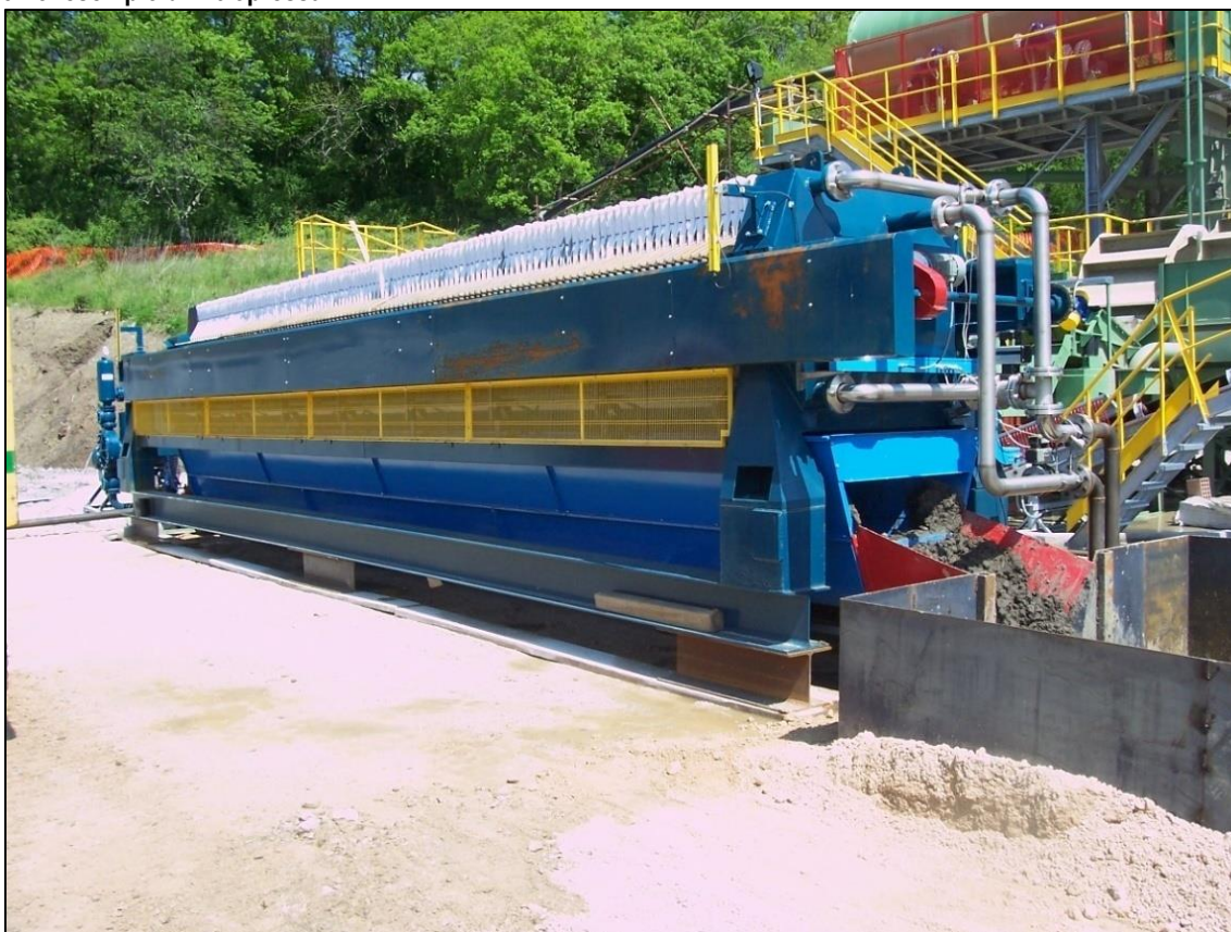
Figura 3-18: esempio di filtropressa
