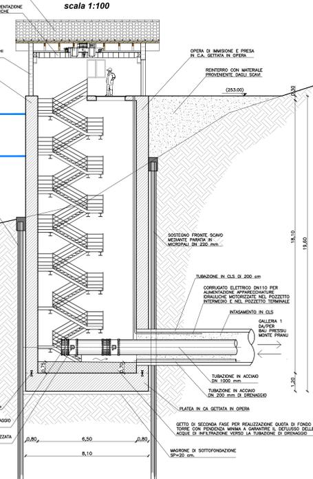
**OPERA DI IMMISSIONE E PRESA LAGO BAU PRESSIU SEZIONE A-A FASE 2 - TUBAZIONE DI IMMISSIONE E PRESA**
