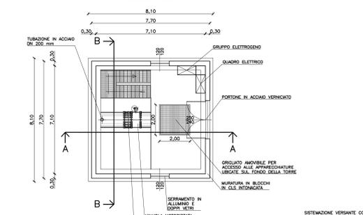
**MANUFATTO DI TESTATA OPERA DI IMMISSIONE E PRESA LAGO BAU PRESSIU PIANTA**
