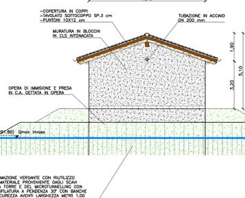
**OPERA DI IMMISSIONE E PRESA LAGO BAU PRESSIU SEZIONE A-A FASE 1 - TORRE**
