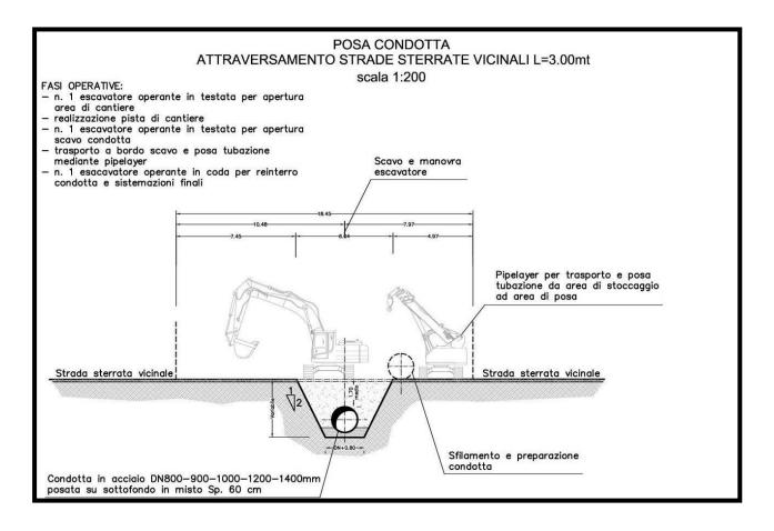
Dopo le fasi di rinterro della condotta si procederà al ripristino della viabilità attraversata con la stesa di uno strato di spaccato di cava di spessore di 30 cm ed uno strato di misto stabilizzato dello spessore di 15 cm.
