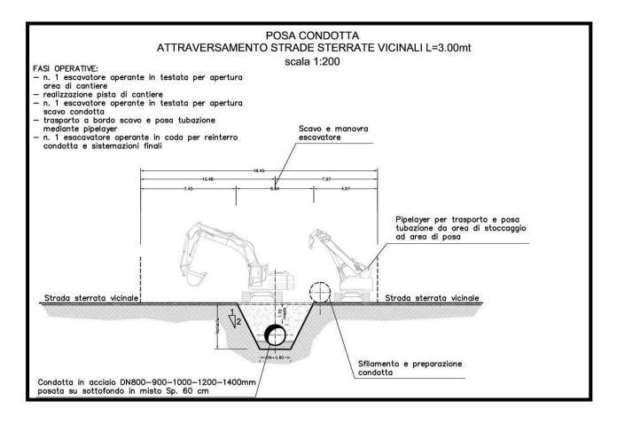
Dopo le fasi di reinterrro della condotta si procederà al ripristino della viabilità attraversata con la stesa di uno strato di spaccato di cava di spessore di 30 cm ed uno strato di misto stabilizzato dello spessore di 15 cm.
