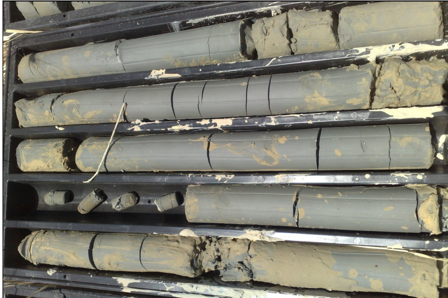
Sondaggio S1: da 20 m a 25 m
