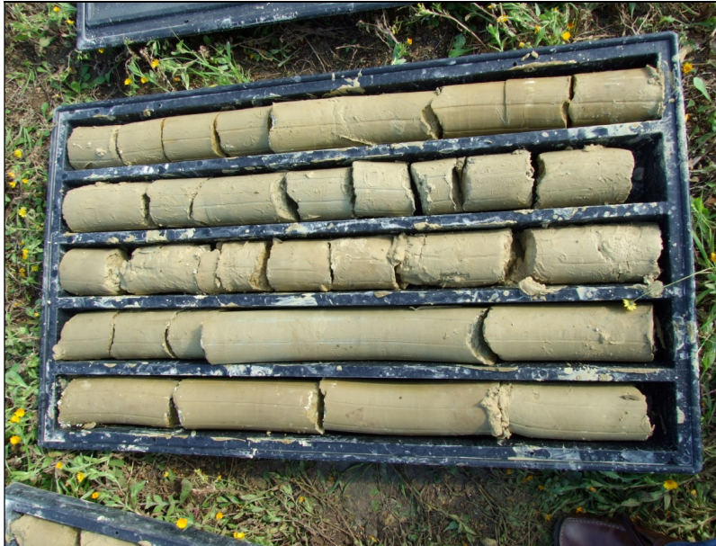
Sondaggio S1: da 10 m a 15 m
