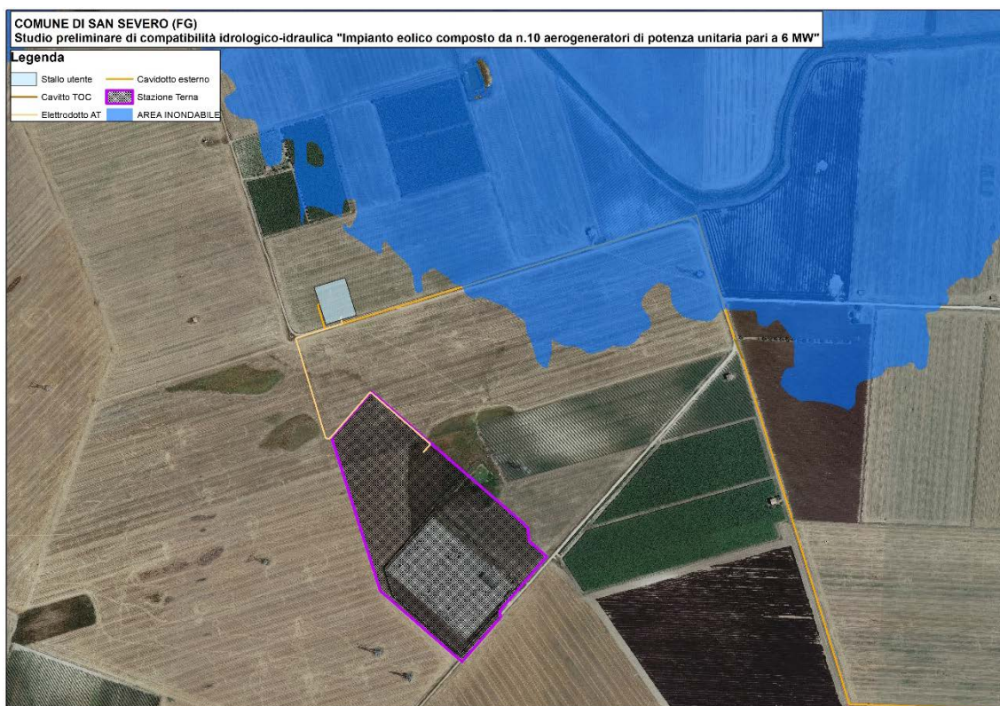
Figura 25: Aree inondabili - Dettaglio area di ubicazione SSE
