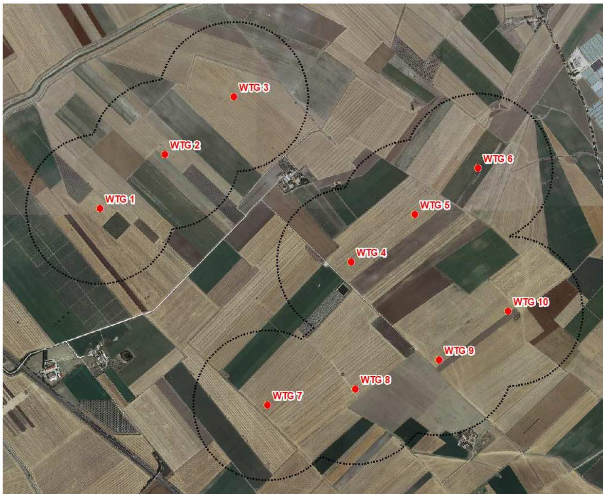
Impianto eolico nel Comune di San Severo in località “La Camera”, costituito da n. 10 per una potenza complessiva di 60 MW comprese le relative opere di connessione alla rete ed infrastrutture indispensabili alla costruzione ed all’esercizio dell’impianto.
