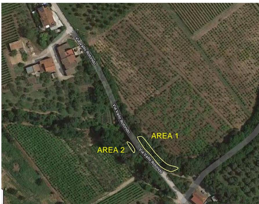
Figura 1: Perimetrazione delle aree instabili lungo la via Vallo Rotondo.
