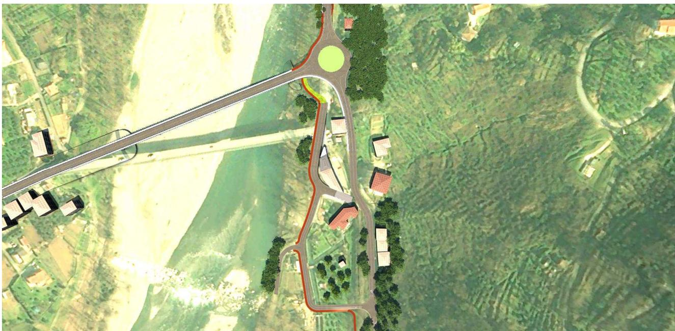
*Rotatoria a Nord dell'attuale spalla in sinistra idraulica*
