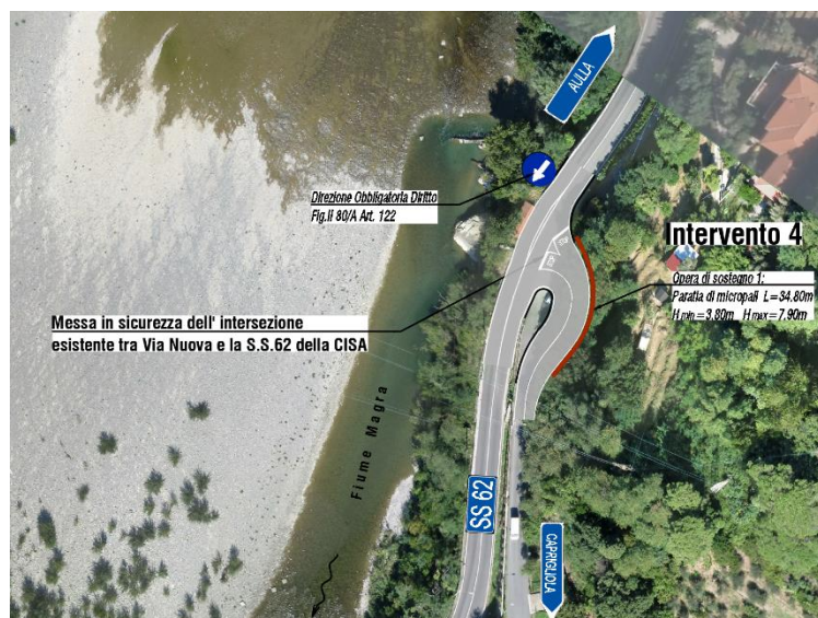
Intersezione tra S.S. 62 e Via Nuova
