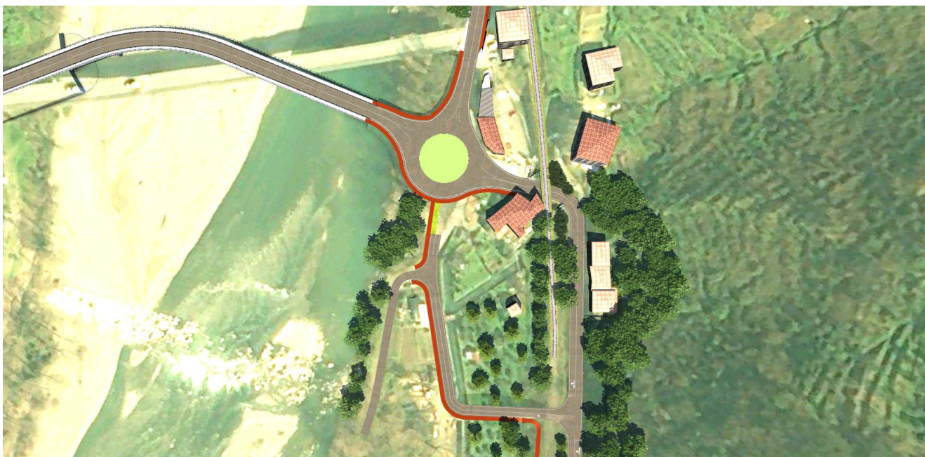
Rotatoria a sud dell'attuale spalla in sinistra idraulica
