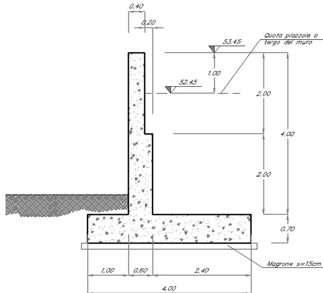
Figura 3 – Sezione trasversale tipo 2
