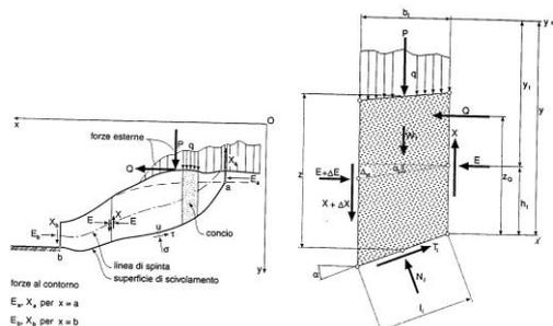
Figura 7 – Schematizzazione di calcolo del metodo delle strisce
