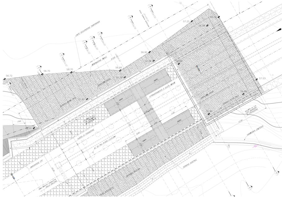
Figura 11: Pianta dell'imbocco lato Canello, sistemazione definitiva
