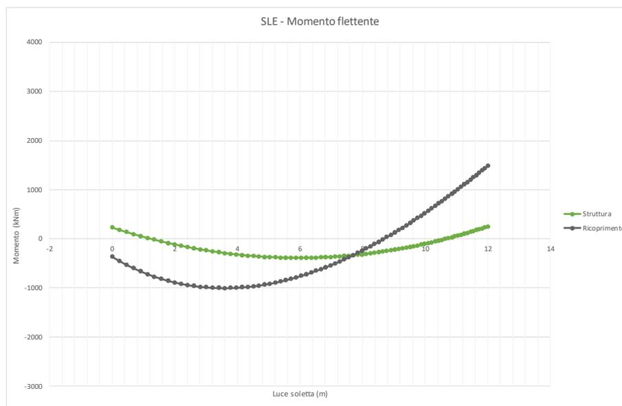
Figura 82: Sezione D – Soletta superiore – Sollecitazione di momento flettente (SLE)
