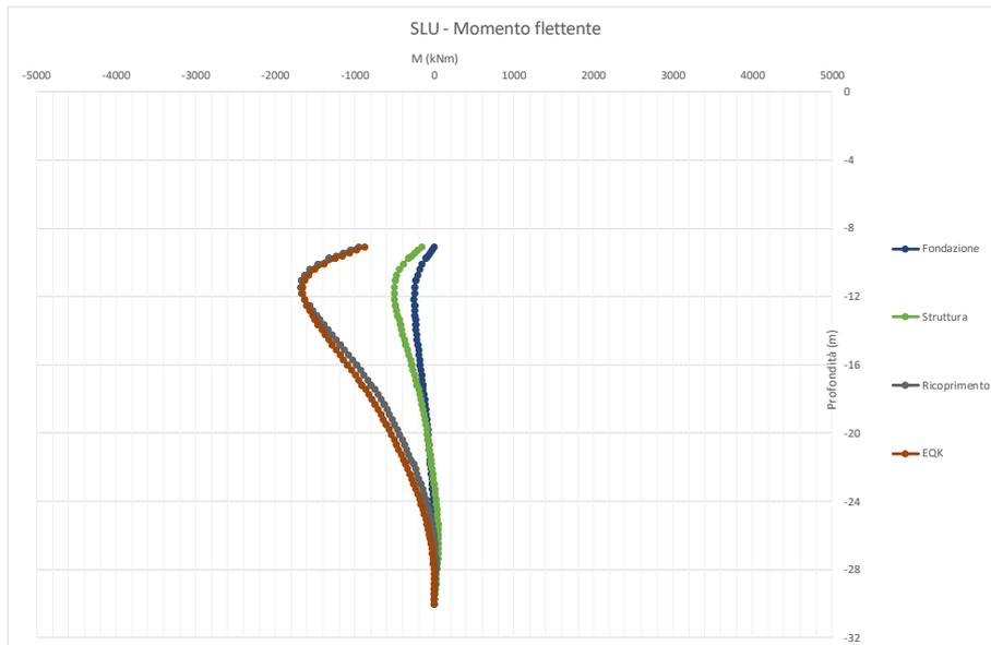
Figura 48: Sezione D – Paratia di Valle (L<sub>p</sub>=20m) – Sollecitazione di momento flettente (SLU)
