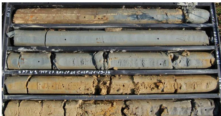
Figura 1: Argille e limi argillosi (MDL3) rinvenuti dal sondaggio S-PE-17 Rif. [IV] Rif. [V]
