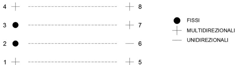
Figura 57: Schema di appoggi impalcato
