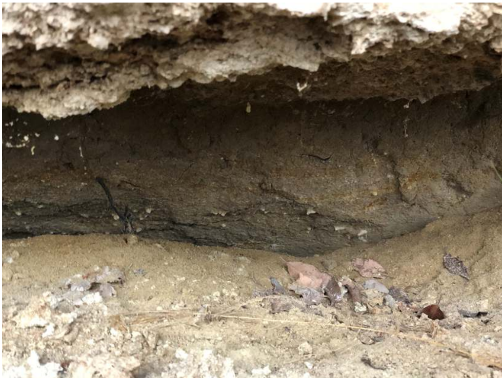
Figura 7: Livelli poco consolidati fini limoso sabbioso e localmente limoso argillosi intercalati ai travertini dell'Unità di Maddaloni.
