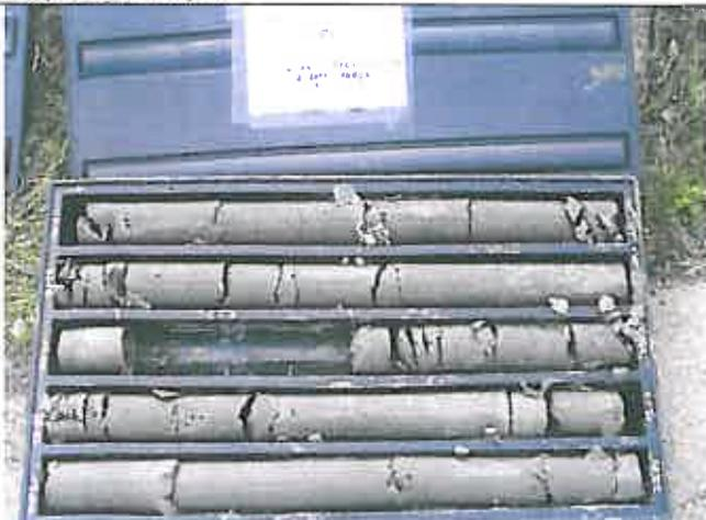
**Foto 6 – Sondaggio SI33 Cassetta catalogatrice 5 da m 20,00 a m 25,00**
