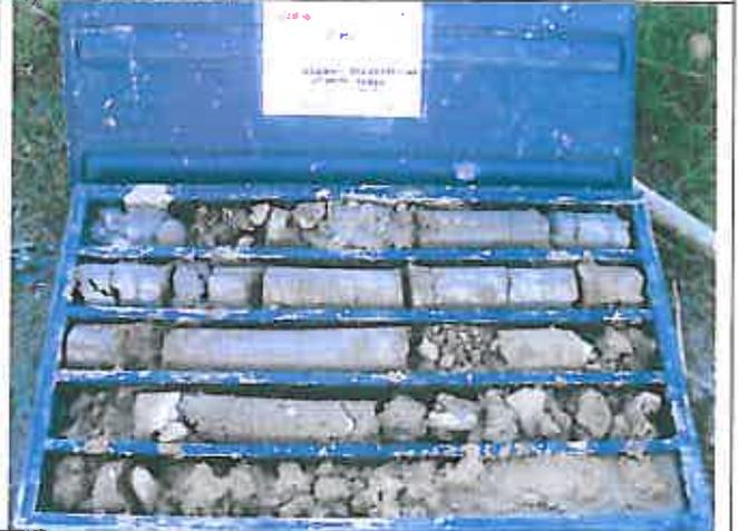
**Foto 3 – Sondaggio SI38 Cassetta catalogatrice 2 da m 5,00 a m 10,00**
