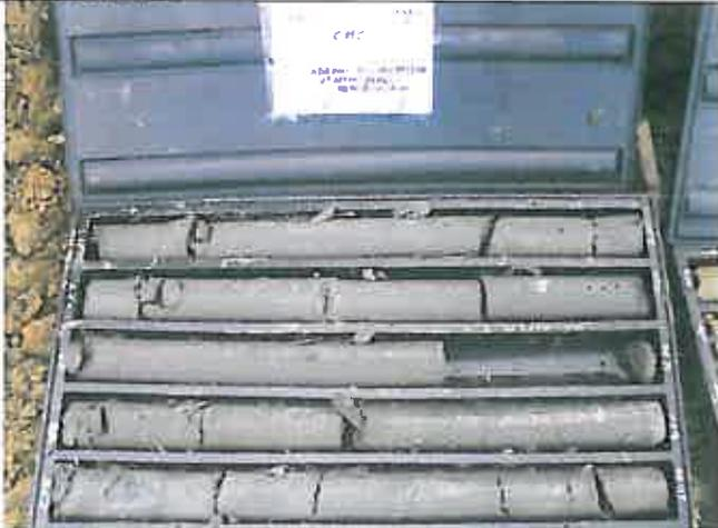
**Foto 4** – Sondaggio SI31 Cassetta catalogatrice 3 da m 10,00 a m 15,00
