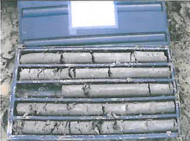
**Foto 6 – Sondaggio SI29 Cassetta catalogatrice 5 da m 20,00 a m 25,00**
