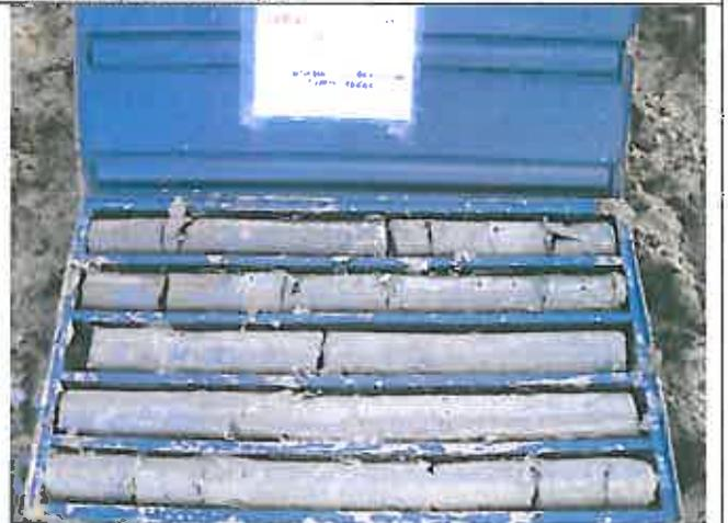
**Foto 5 – Sondaggio SI29 Cassetta catalogatrice 4 da m 15,00 a m 20,00**
