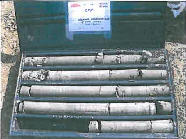
**Foto 6 – Sondaggio SI34 Cassetta catalogatrice 5 da m 20,00 a m 25,00**
