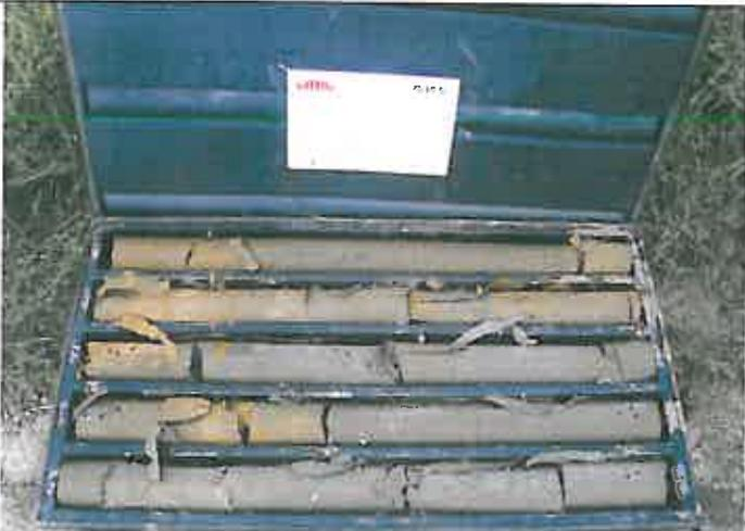
**Foto 4** – Sondaggio SI23 Cassetta catalogatrice 3 da m 10,00 a m 15,00
