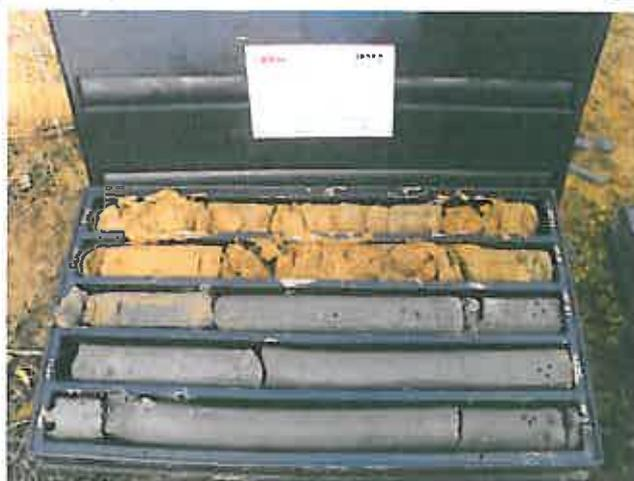
**Foto 5 – Sondaggio SI25 Cassetta catalogatrice 4 da m 15,00 a m 20,00**
