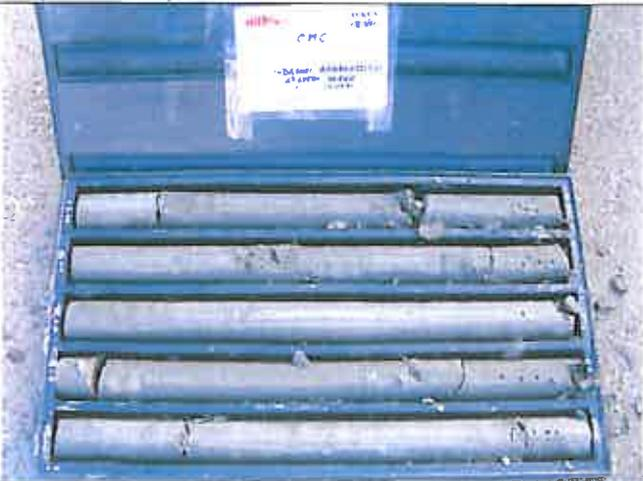
**Foto 6 – Sondaggio SI37 Cassetta catalogatrice 5 da m 20,00 a m 25,00**
