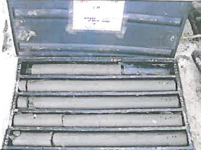
**Foto 8 – Sondaggio SI26 Cassetta catalogatrice 7 da m 30,00 a m 35,00**
