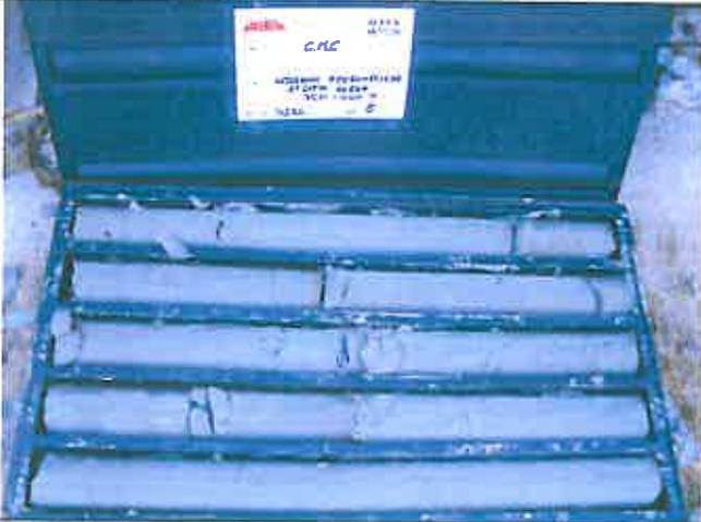
**Foto 10 – Sondaggio SI26 Cassetta catalogatrice 9 da m 40,00 a m 45,00**
