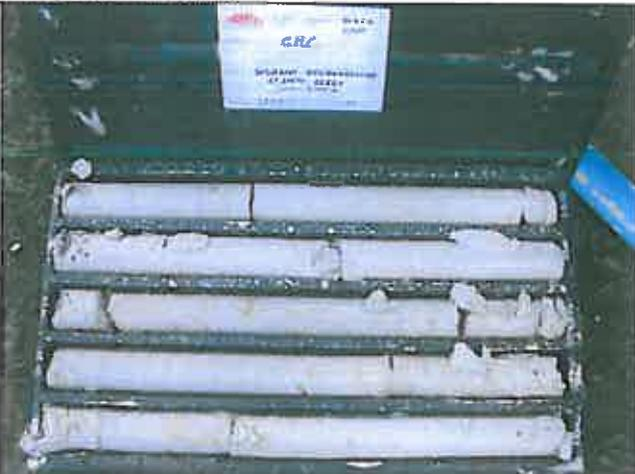
**Foto 12** – Sondaggio SI27 Cassetta catalogatrice 11 da m 50,00 a m 55,00
