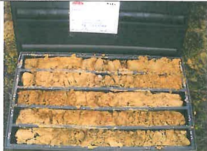
**Foto 4 – Sondaggio SI25 Cassetta catalogatrice 3 da m 10,00 a m 15,00**
