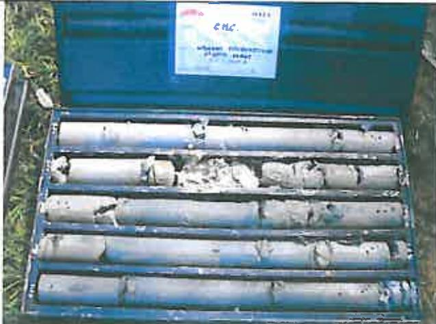
**Foto 4** – Sondaggio SI27 Cassetta catalogatrice 3 da m 10,00 a m 15,00
