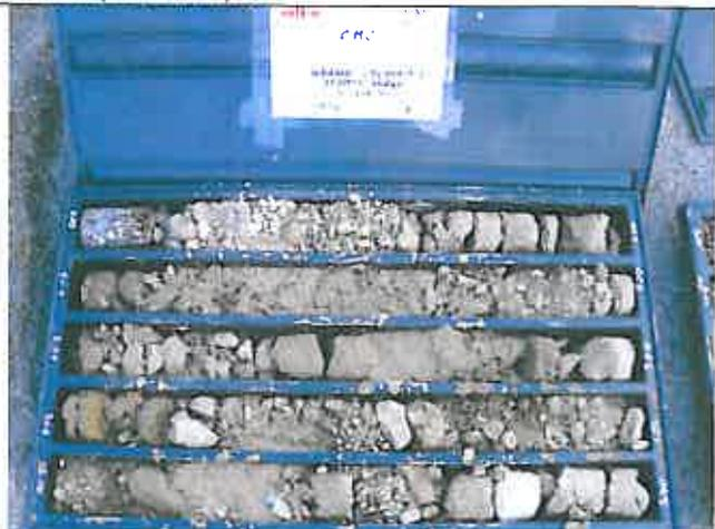
**Foto 3 – Sondaggio SI37 Cassetta catalogatrice 2 da m 5,00 a m 10,00**
