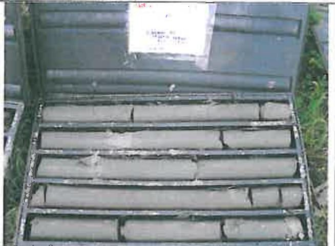
**Foto 9** – Sondaggio SI26bis Cassetta catalogatrice 8 da m 35,00 a m 40,00
