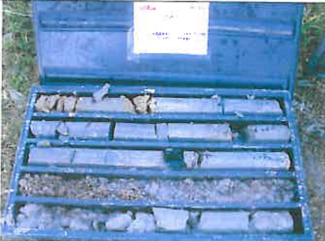
**Foto 4 – Sondaggio SI38 Cassetta catalogatrice 3 da m 10,00 a m 15,00**
