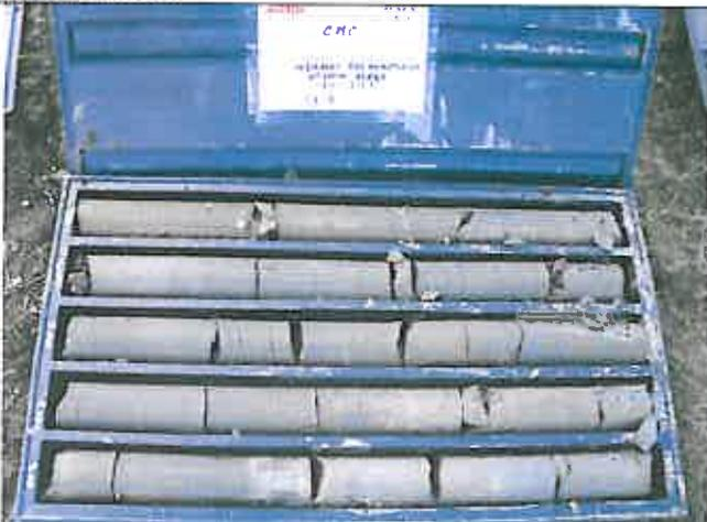
**Foto 4 – Sondaggio SI35 Cassetta catalogatrice 3 da m 10,00 a m 15,00**
