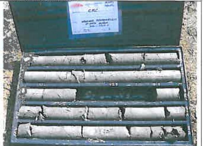
**Foto 9** – Sondaggio SI34 Cassetta catalogatrice 8 da m 35,00 a m 40,00
