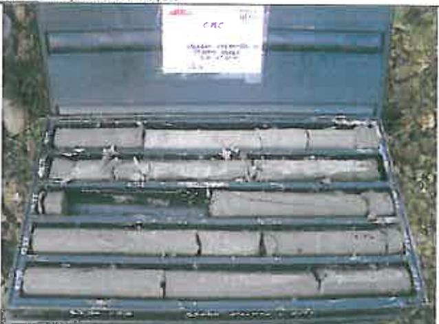
**Foto 5** – Sondaggio SI30 Cassetta catalogatrice 4 da m 15,00 a m 20,00
