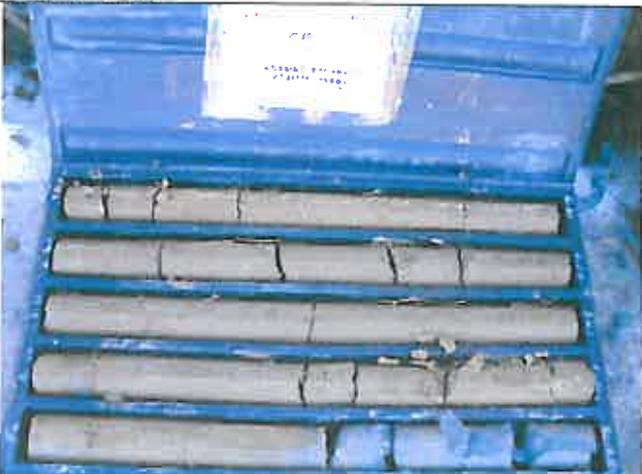
**Foto 4 – Sondaggio SI26 Cassetta catalogatrice 3 da m 10,00 a m 15,00**
