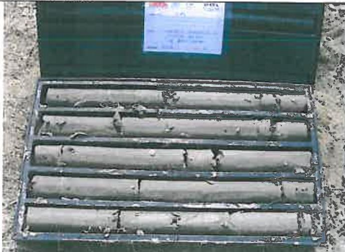
**Foto 4** – Sondaggio SI24 Cassetta catalogatrice 3 da m 10,00 a m 15,00
