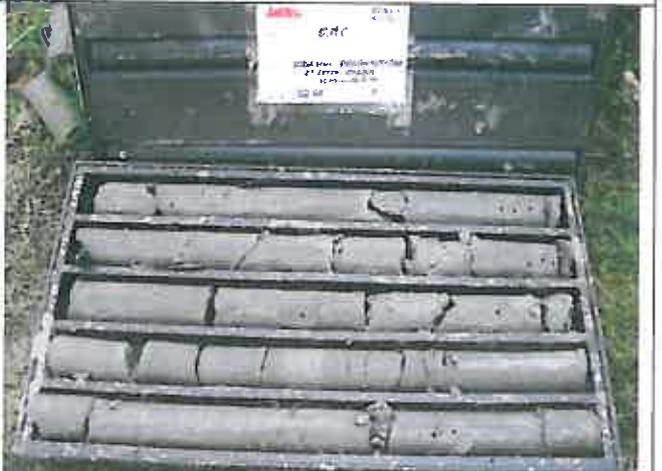
**Foto 5 – Sondaggio SI38 Cassetta catalogatrice 4 da m 15,00 a m 20,00**
