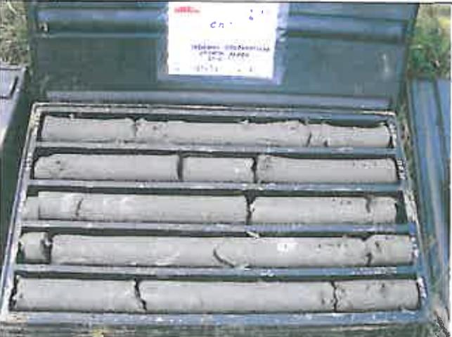
**Foto 6 – Sondaggio SI26bis Cassetta catalogatrice 5 da m 20,00 a m 25,00**
