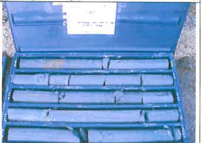
**Foto 5 – Sondaggio SI32 Cassetta catalogatrice 4 da m 15,00 a m 20,00**
