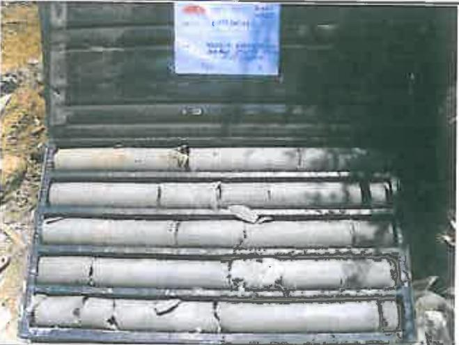
**Foto 6 – Sondaggio PZ3 Cassetta catalogatrice 5 da m 20,00 a m 25,00**
