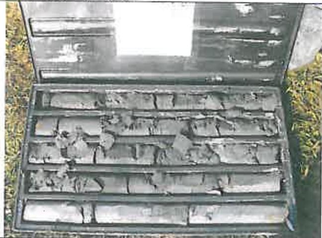
**Foto 6** – Sondaggio SI41 Cassetta catalogatrice 5 da m 20,00 a m 25,00
