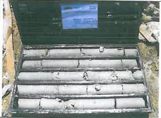
**Foto 11** – Sondaggio PZ3 Cassetta catalogatrice 10 da m 45,00 a m 50,00
