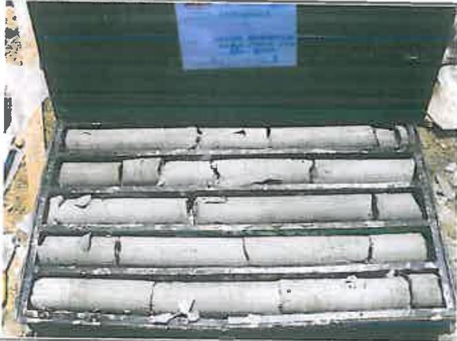
**Foto 10** – Sondaggio PZ3 Cassetta catalogatrice 9 da m 40,00 a m 45,00
