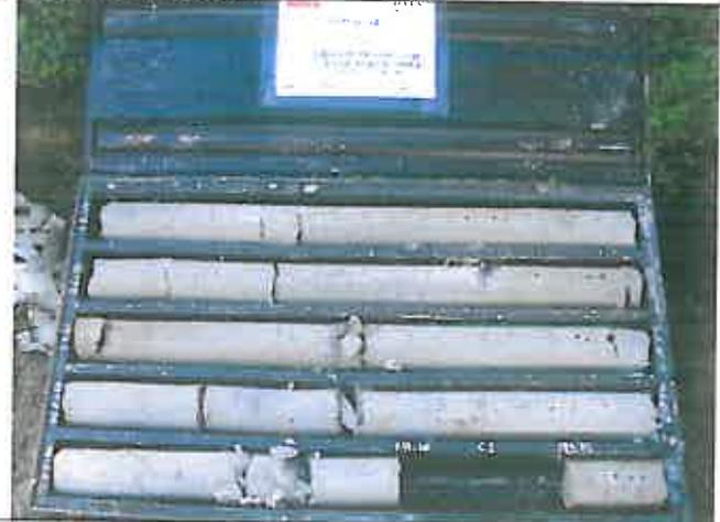
**Foto 4** – Sondaggio SI40 Cassetta catalogatrice 3 da m 80,00 a m 85,00
