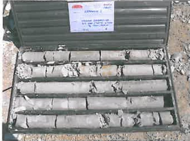
**Foto 8** – Sondaggio SI44 Cassetta catalogatrice 7 da m 85,00 a m 90,00
