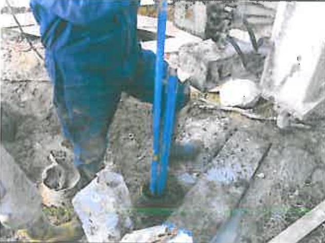
**Foto 28** – Sondaggio SI41 Rilevo piezometrico
