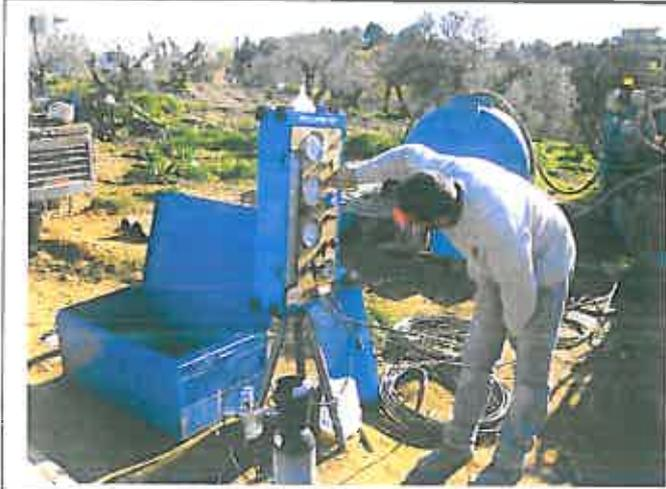
**Foto 16** – Sondaggio SI42 Tubi piezometrici Casagrande (rilievo di falda)
