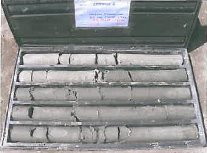
**Foto 16** – Sondaggio SI46 particolare carota a m 87,80
