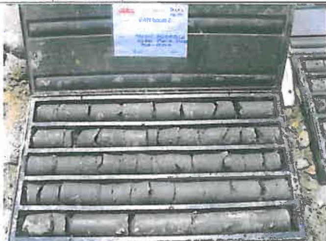
**Foto 12** – Sondaggio SI43 Cassetta catalogatrice 11 da m 100,00 a m 105,00
