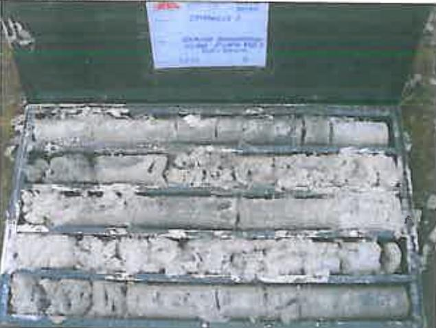
**Foto 6** – Sondaggio SI42 Cassetta catalogatrice 5 da m 80,00 a m 85,00
