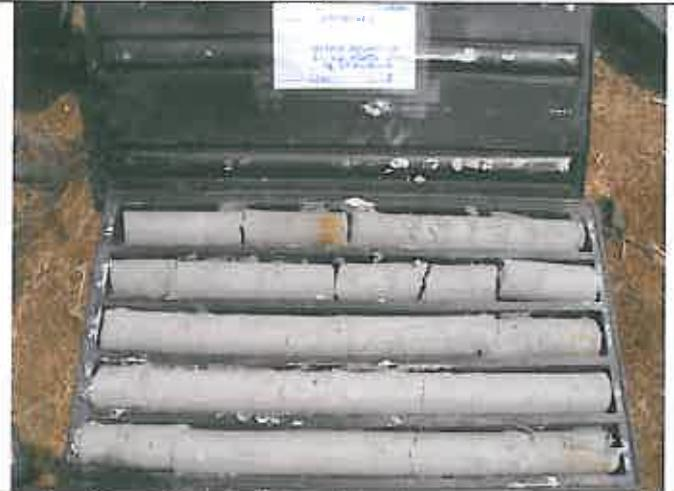
**Foto 9** – Sondaggio SI45 Cassetta catalogatrice 8 da m 95,00 a m 100,00
