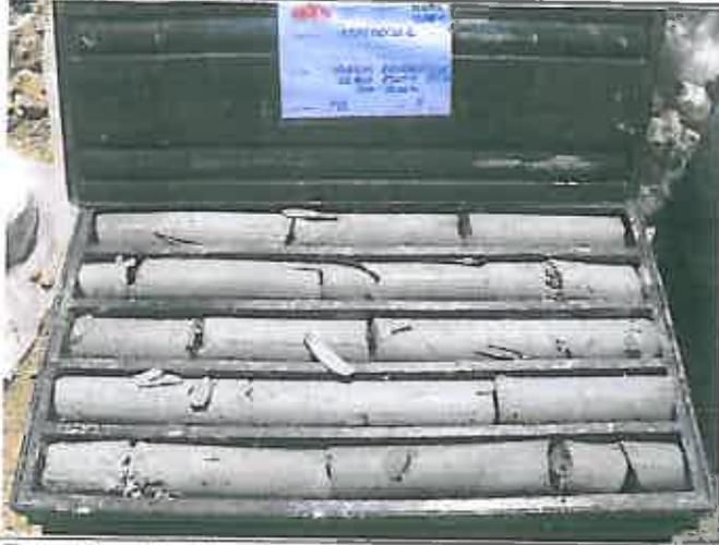
**Foto 8** – Sondaggio PZ3 Cassetta catalogatrice 7 da m 30,00 a m 35,00
