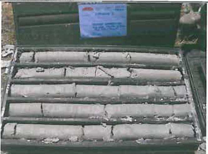
**Foto 6** – Sondaggio SI44 Cassetta catalogatrice 5 da m 75,00 a m 80,00
