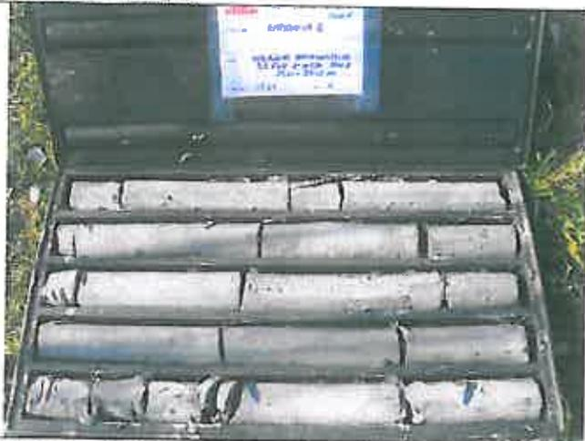
**Foto 8** – Sondaggio SI41 Cassetta catalogatrice 7 da m 30,00 a m 35,00
