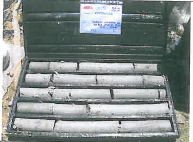
**Foto 9** – Sondaggio PZ3 Cassetta catalogatrice 8 da m 35,00 a m 40,00
