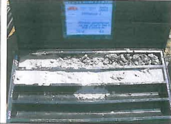
**Foto 14** – Sondaggio SI42 dettaglio carota
