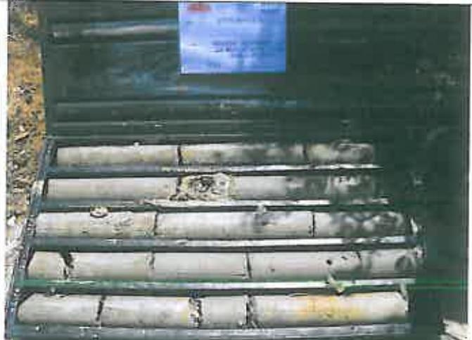
**Foto 5 – Sondaggio PZ3 Cassetta catalogatrice 4 da m 15,00 a m 20,00**
