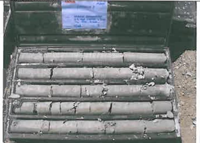
**Foto 9** – Sondaggio SI44 Cassetta catalogatrice 8 da m 90,00 a m 95,00
