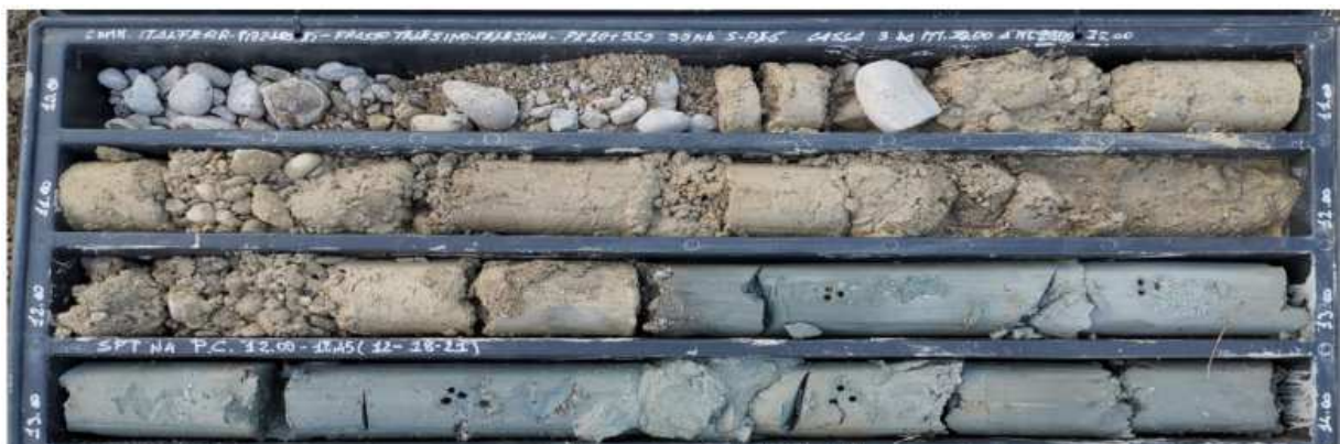
Foto 12 – livelli ghiaioso sabbiosi afferenti alle alluvioni recenti del fiume Calore in corrispondenza del contatto erosivo con le sottostanti argille di Maddaloni (MDL3)
