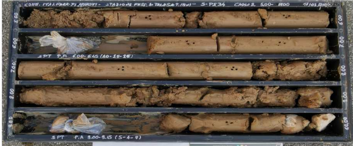
Foto 10 – depositi limo argillosi di color marrone ascrivibili alla litofacies (bc3) recuperati lungo il sondaggio S-PE34.
