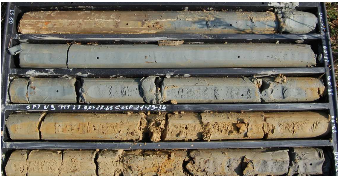
Foto 3 – argille e limi argillosi grigio azzurri dell'unità di Maddaloni rinvenuti dal sondaggio S-PE-17 alla profondità di circa 25m. In evidenza il profilo d'alterazione color nocciola dei livelli alto stratigrafici.
