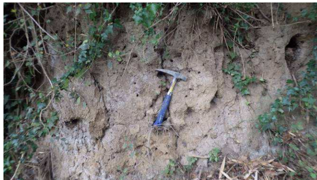
Figura 27 - a) Muro e opere di contenimento a valle dei fenomeni franosi presenti tra il km 18+100 e 18+300, prive di lesioni e/o deformazioni; b) affioramento dei termini vulcanoclastici del Tufo Grigio Campano a valle della linea esistente.
