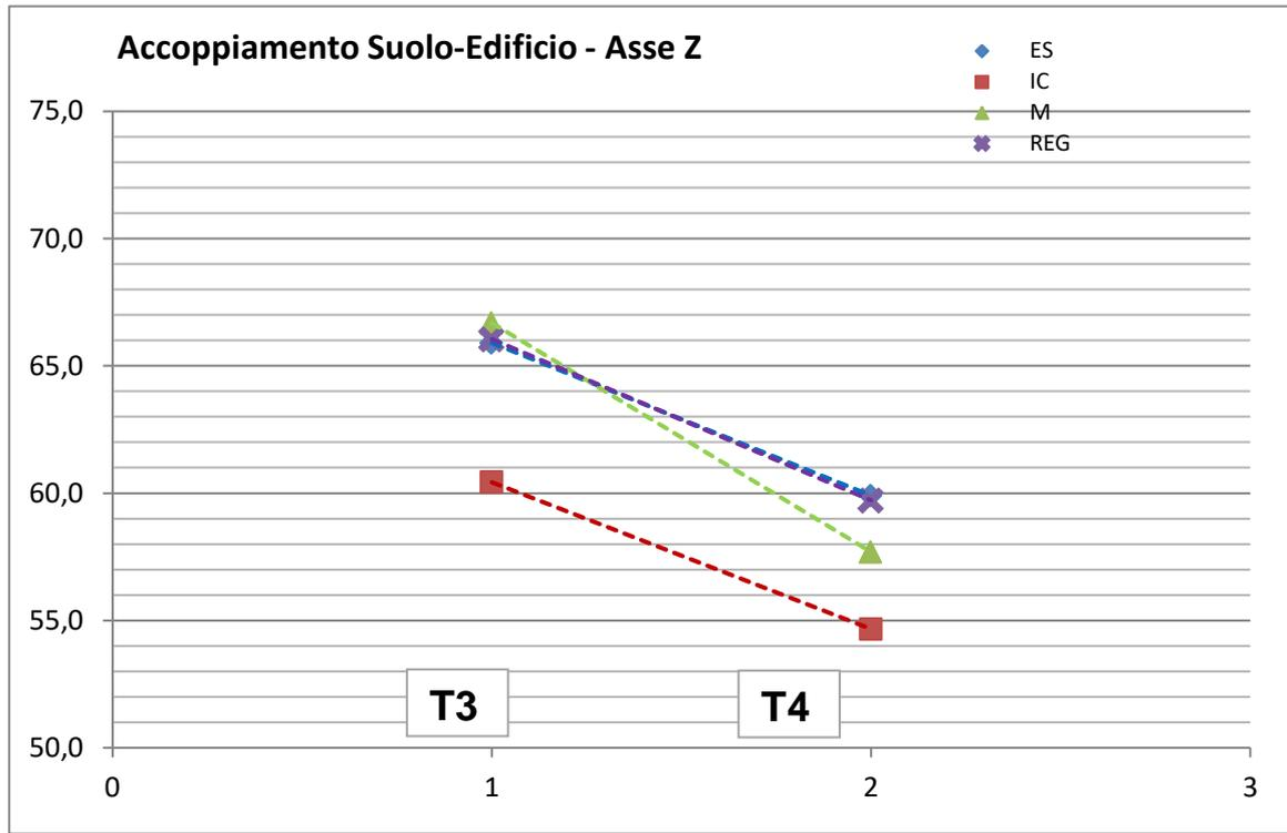
*Attenuazione complessiva per accoppiamento suolo-fondazioni e amplificazione risonanza solaio, ricavata dai rilievi sperimentali del Leq,te sull'attuale linea in esercizio, lungo l'asse Z*
