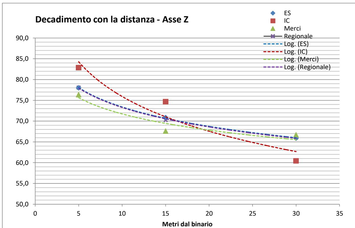
*Curva di attenuazione del  $Leq,te$  in funzione della distanza dal binario, ricavata dai rilievi sperimentali sull'attuale linea in esercizio lungo l'asse Z, in corrispondenza della Terna 1 (5 metri), della Terna 2 (15 metri) e della Terna 3 (30 metri).*
