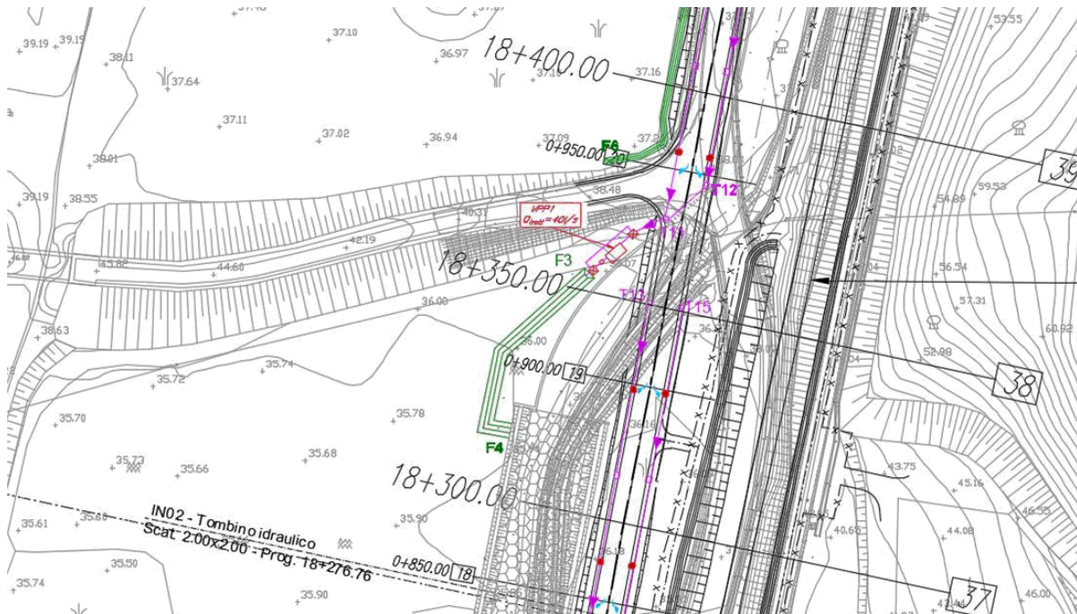
Particolare dell'interferenza con l'opera idraulica
