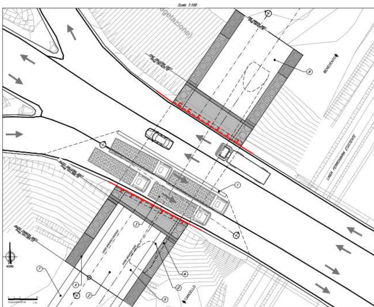
Figura 25: Fase 3 – Apertura al Traffico
