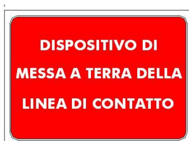
Figura 32 - Segnaletica di emergenza – Dispositivo di messa a terra della linea di contatto
