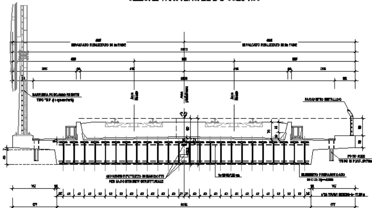
Figura 2 – Impalcato a travi incorporate luce L=22.00m
