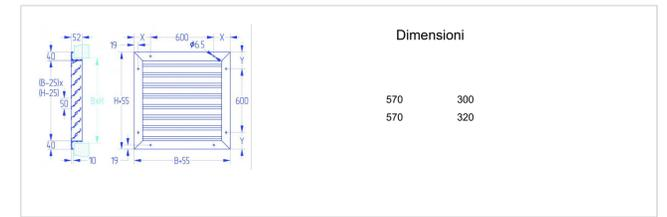
PARTICOLARE DIMENSIONALE SERRANDE DI PRESA ED ESPULSIONE ARIA
