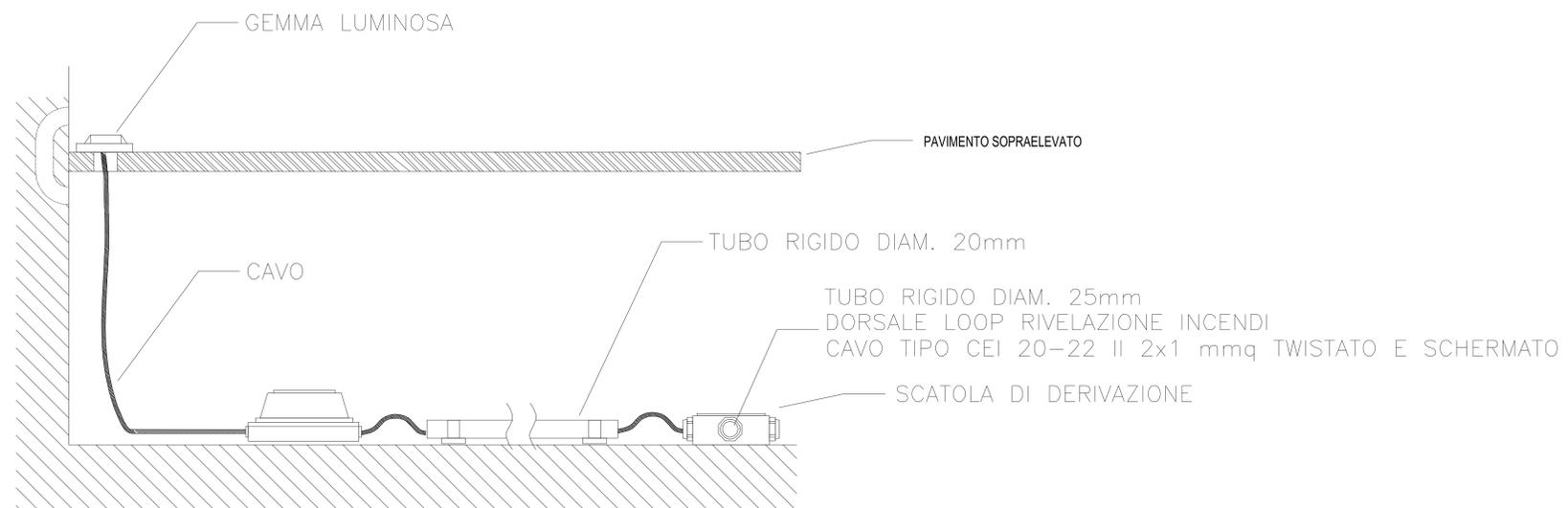
PARTICOLARE COLLEGAMENTO RIVELATORE SOPRA E SOTTO CONTROSOFFITTO
