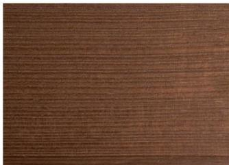
Dopo completa essiccazione, il legno subisce un trattamento termico a temperatura di circa 200° e umidità finale attorno al 5%. A seguito del trattamento il materiale assume colorazione marrone e ottima stabilità dimensionale.
