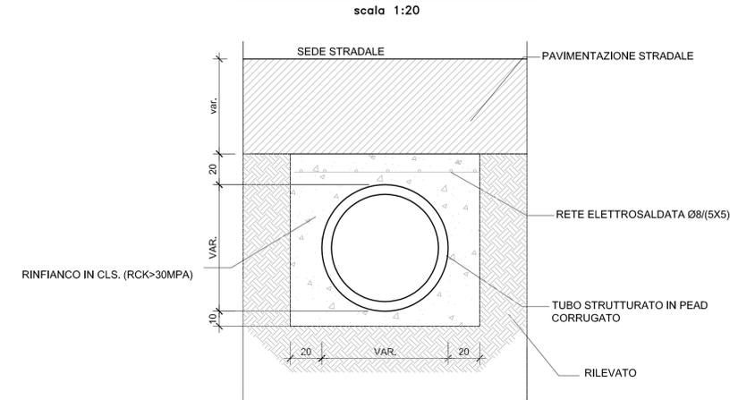
PARTICOLARE ELEMENTO DI RACCORDO FOSSI RIVESTITI
