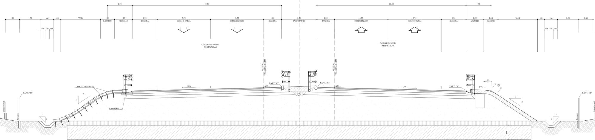
**DETTAGLIO EMBRICE SEZIONE STRADA PRINCIPALE IN RILEVATO IN RETTIFILO**
