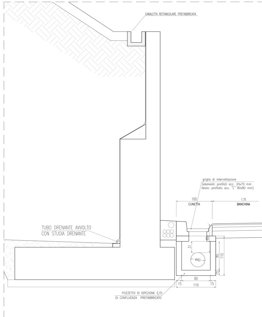
PARTICOLARE POZZETTO IDRAULICO AI PIEDI DEL MURO
