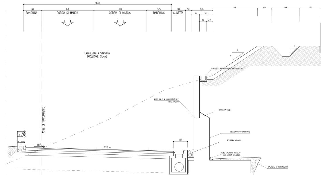
PARTICOLARE POZZETTO IDRAULICO AI PIEDI DEL MURO
