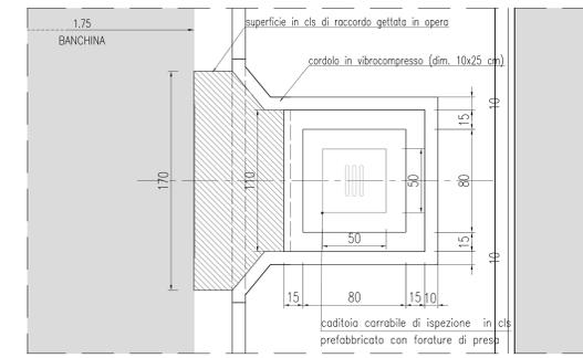
PARTICOLARE POZZETTO IDRAULICO IN MEZZERIA
