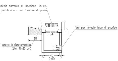
PARTICOLARE POZZETTO IDRAULICO IN MEZZERIA
