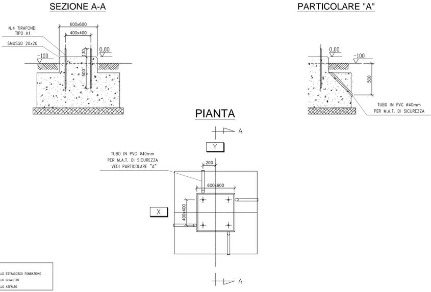
**FONDAZIONE PER SUPPORTO SBARRE TRIPOLARE**
