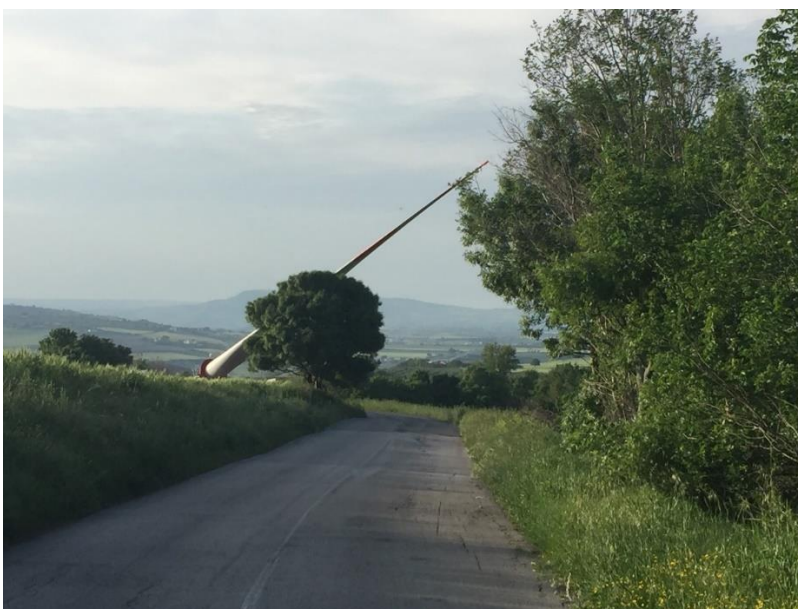
Figura 3 – Mezzo con dispositivo “alza pala” a trazione propria in un contesto di strada rurale
