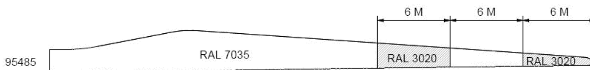
Figura 5 – Schema indicativo colorazione pale (la larghezza effettiva delle bande colorate sarà apposta in accordo con quanto specificato in Tabella 6.1)
