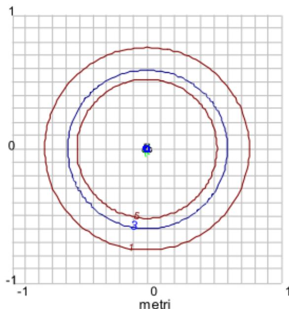
Figura 5.2 - Curve equilivello dell'induzione magnetica generata da cavi cordati ad elica.
