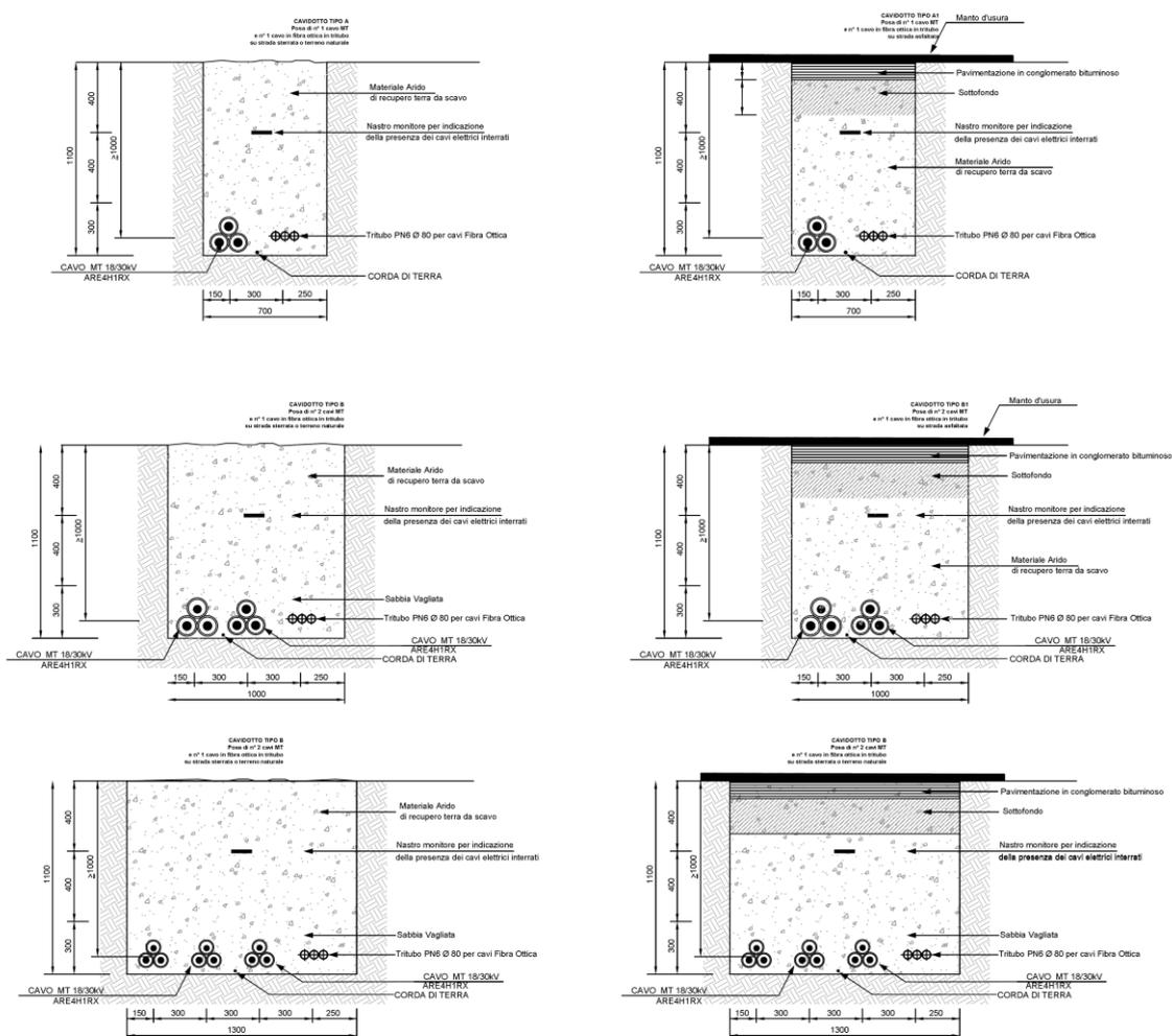
Figura 5.1 – Cavidotti in progetto tipo ARE4H1RX 18/30kV con sezioni variabili 50 a 300mm<sup>2</sup>
