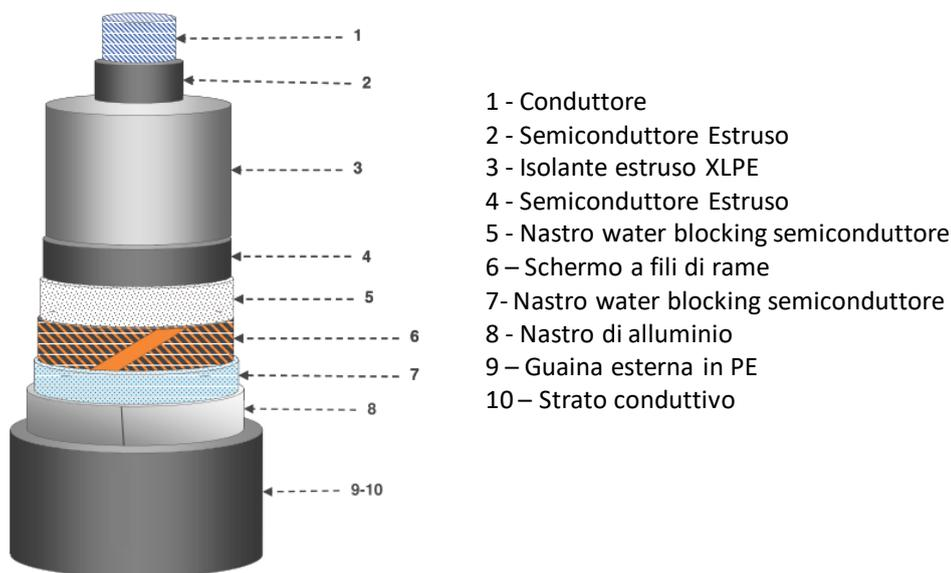
Figura 3.4 - Cavo AT 150 kV tipo ARE4H1H5E 87/150kV
