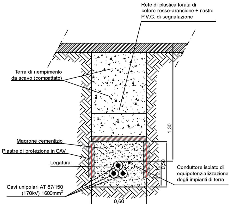
Figura 3.5 - Modalità di posa Cavo AT 150 kV
