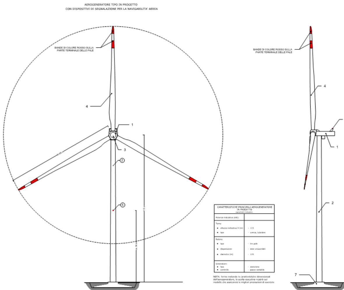
Figura 3.2 – Aerogeneratore tipo SG170 - 6 MW altezza al mozzo (1) 115 m, e diametro rotore (2) di 170 m
