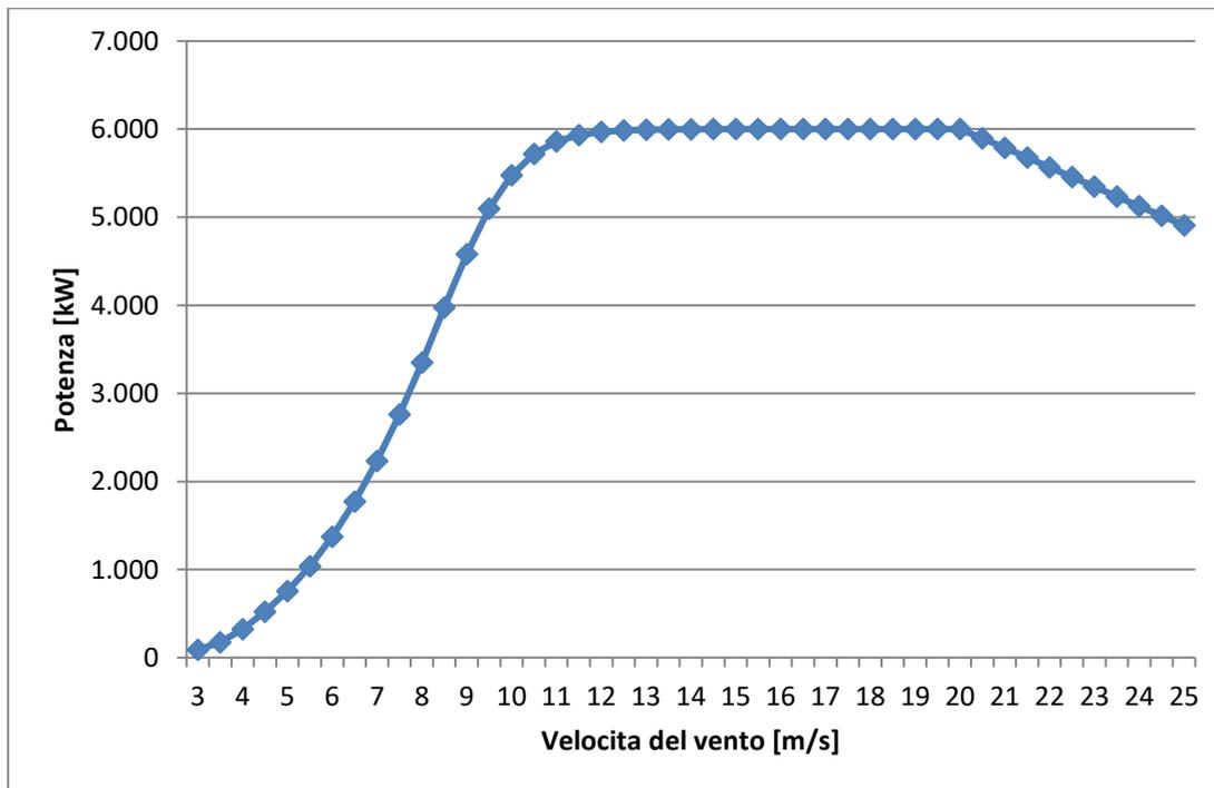
Figura 3.3 – Curva di potenza generatore tipo SG 6.0-170
