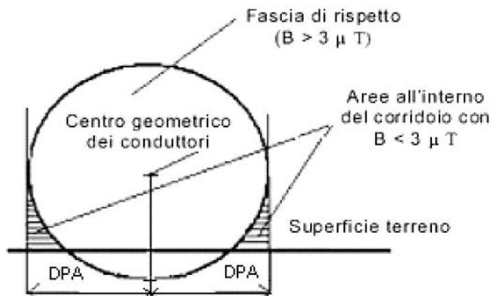
Figura 2.2- Calcolo della DPA per un elettrodotto
