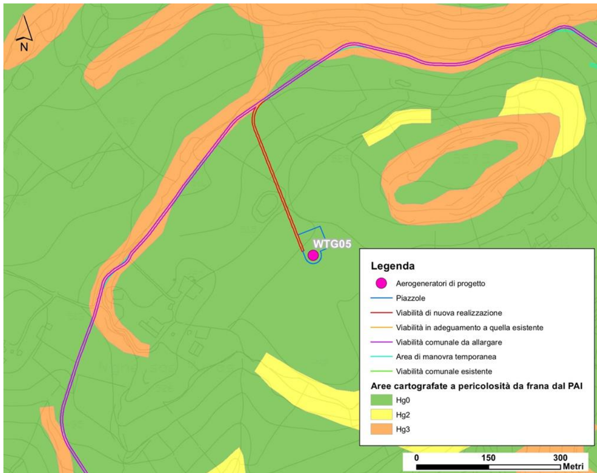
Figura 3.10 - Locale sovrapposizione della viabilità comunale ad aree a pericolosità da frana Hg3 "Elevata"
