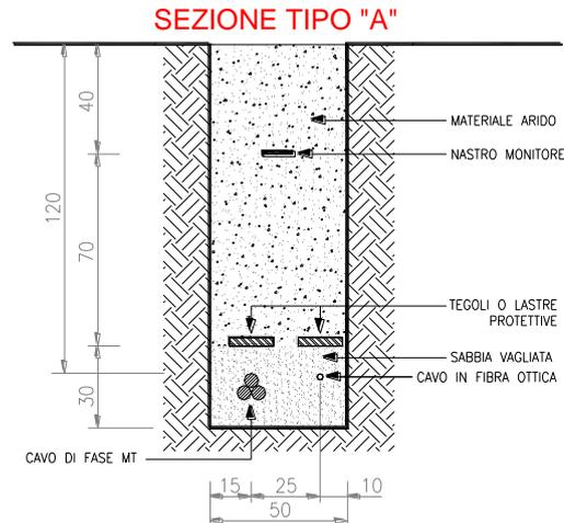
Fig. 5 Sezione tipica di posa della linea in cavo su strade sterrate
