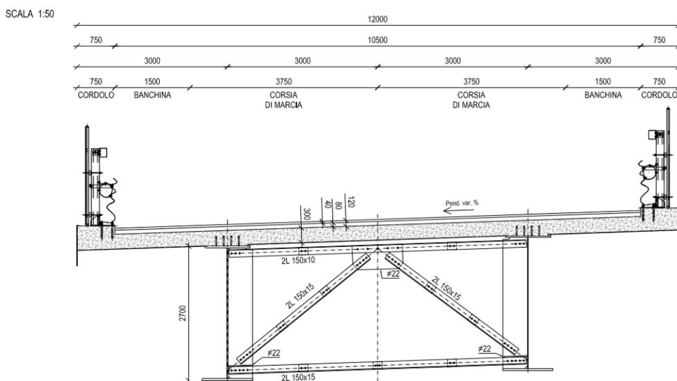
Figura 19: Viadotto Ellero - sezione trasversale corrente
