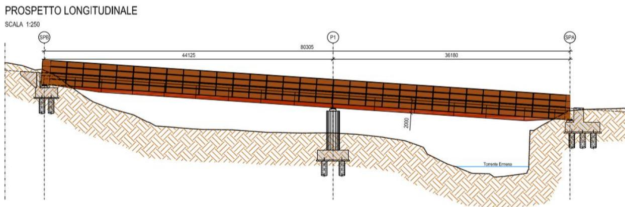
Figura 20: Ponte sul Torrente Ermena - Profilo longitudinale
