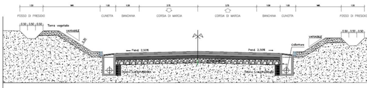
Figura 14: Asse principale – Sezione tipo rilevato
