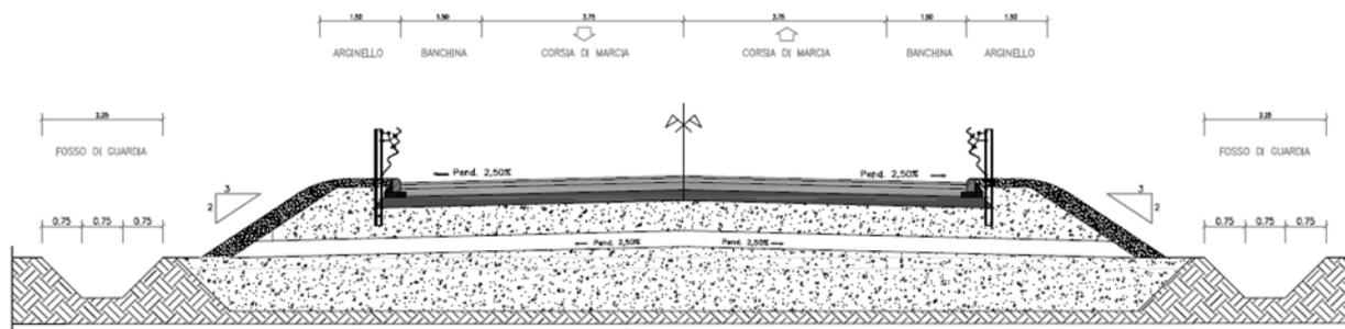
Figura 13: Asse principale – Sezione tipo rilevato
