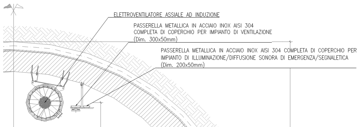
Figura 57: Infrastruttura Galleria naturale – impianti illuminanti
