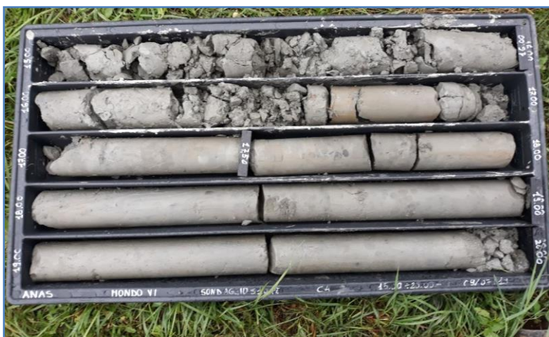
Figura 15 Marne di S Agata Fossili nel sondaggio S10 fra 10-15 m da p.c.
