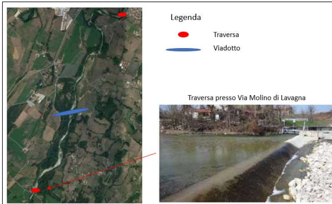
Figura 8: Tratto del fiume Ellero oggetto di studio, con l'indicazione delle traverse esistenti tratto da Carta alveo-tipi e portate – BDGeo100 – Arpa Piemonte.
