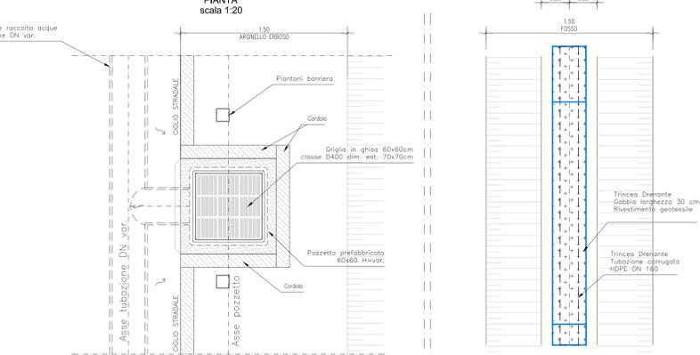
**VIADOTTO - RACCOLTA ACQUE METEORICHE IN IN BANCHINA CON CORDOLO**
