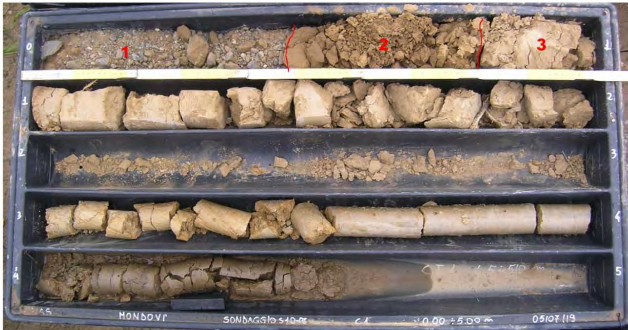
Figura 17: Area 1b: sondaggio SD10-pz. Sequenza stratigrafica
