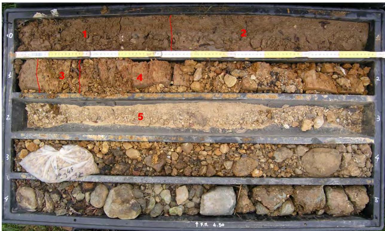
Figura 12: Area 1a: sondaggio SP2-pz. Sequenza stratigrafica
