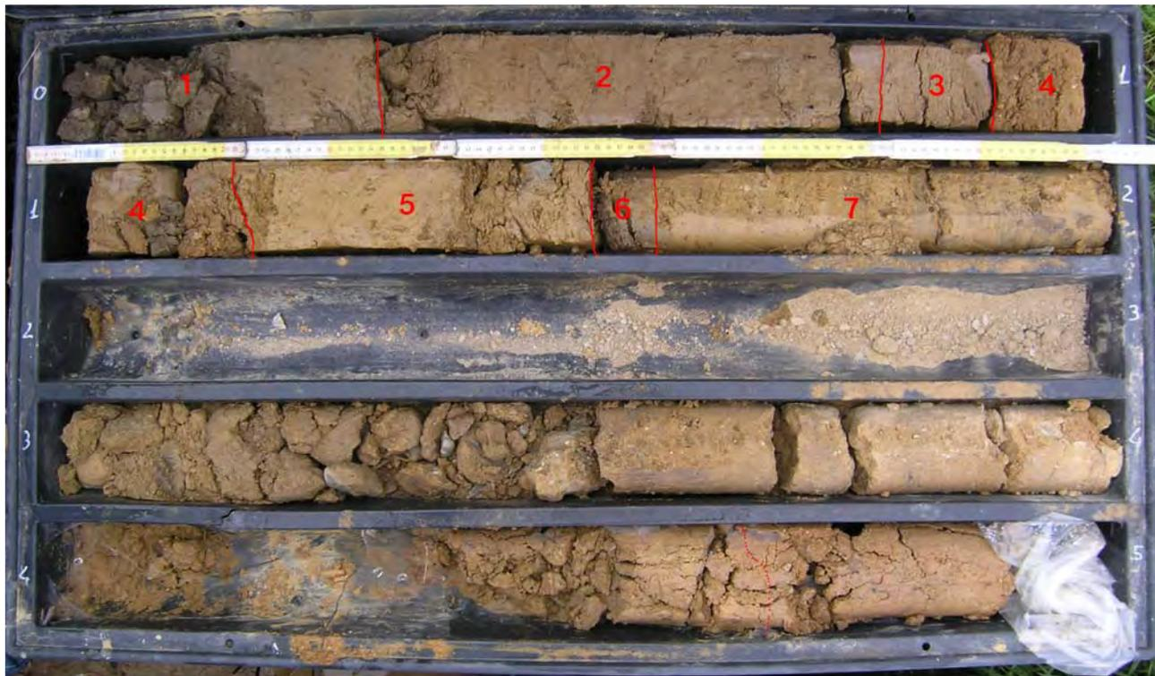
Figura 18: Area 2: sondaggio SD13-i. Sequenza stratigrafica
