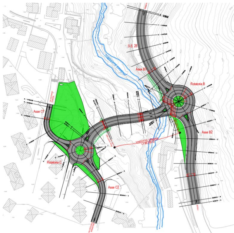
Figura 4.2 Asse secondario – Collegamento Rione Borgato con S.S.28
