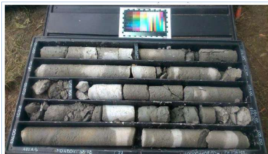
Figura 2-164 Arenarie (della F.ne di Lequio) nel sondaggio S8 fra 100-105 m da p.c.
