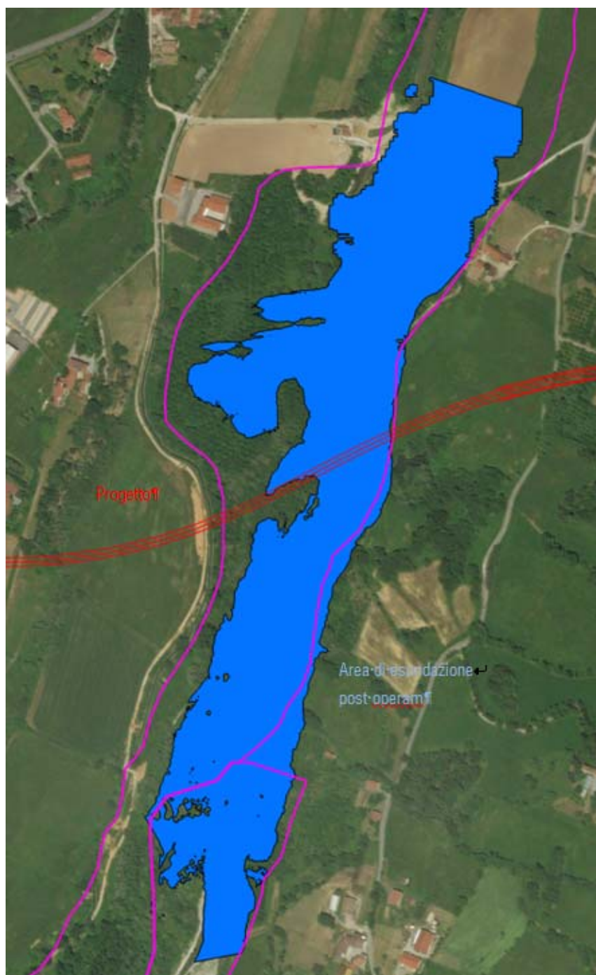
Figura 3.10: Area di esondazione del fiume Ellero con Q_{T200} . Lo stato di fatto coincide con l'area di esondazione post operam
