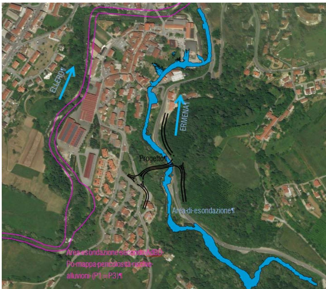
Figura 3.12: Area di esondazione modellata del torrente Ermena con Q_{T200}=104 \text{ m}^3/\text{s} . Si evince l'assenza di mappatura inerente all'area di esondazione del AdBD del Po (dalla relazione idraulica di progetto)
