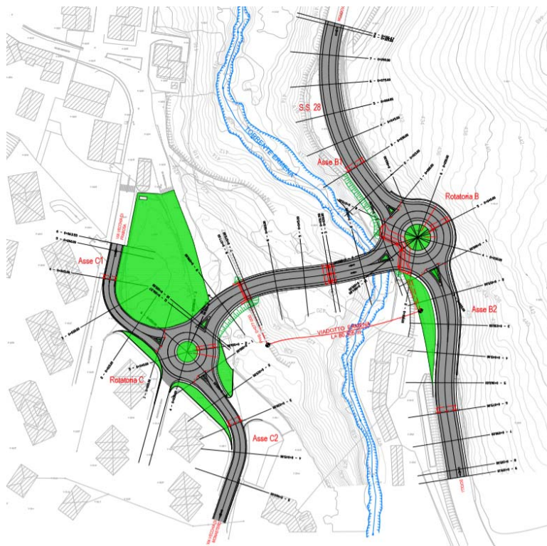
Figura 5.3 Asse secondario – Collegamento Rione Borgato con S.S.28
