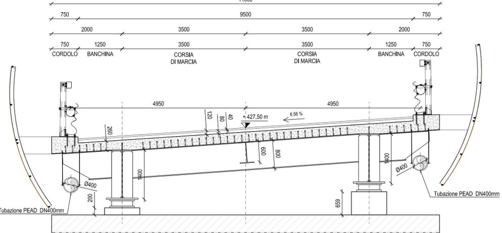
SEZIONE TRASVERSALE - PILA "P1"
