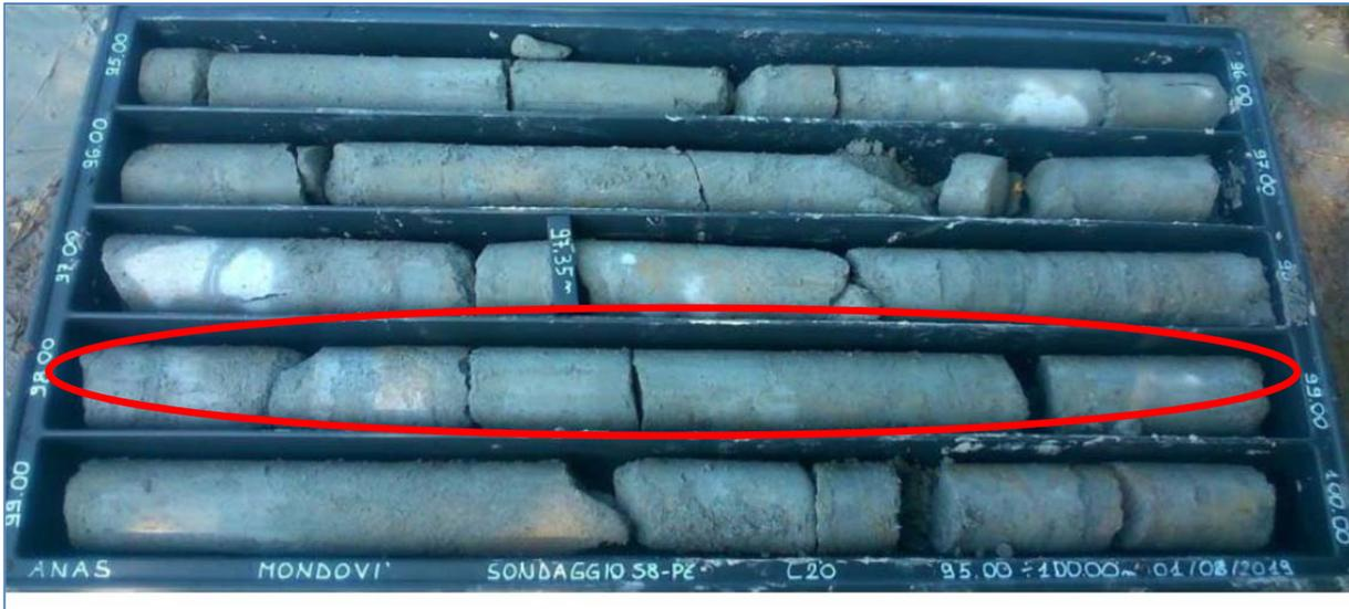
Figura 7.19 Stralcio foto cassetta sondaggio S8 dove fra 98-99 m è stato prelevato il CR1
