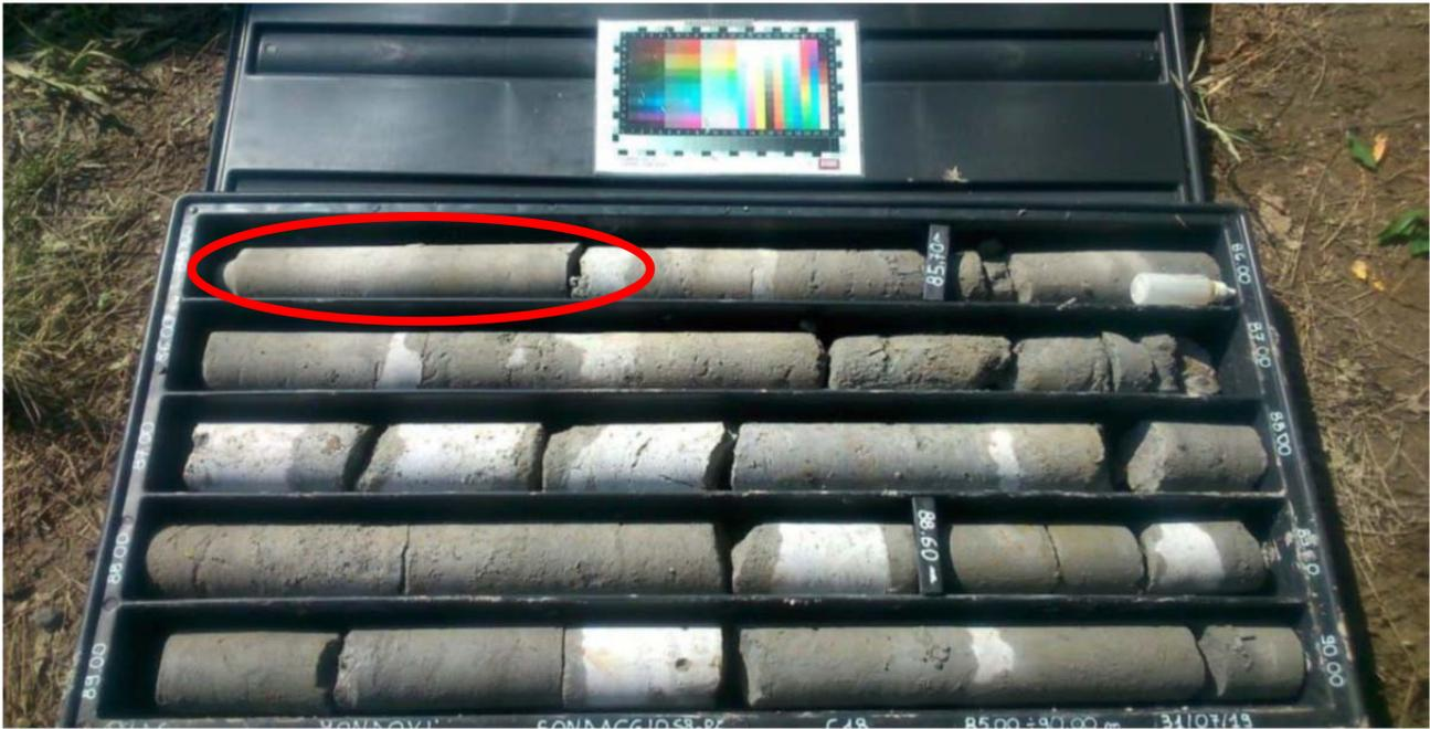
Figura 7.23 Stralcio foto cassetta sondaggio S8 dove a 85 m è stata eseguita la prova dilatometrica con risultato anomalo
