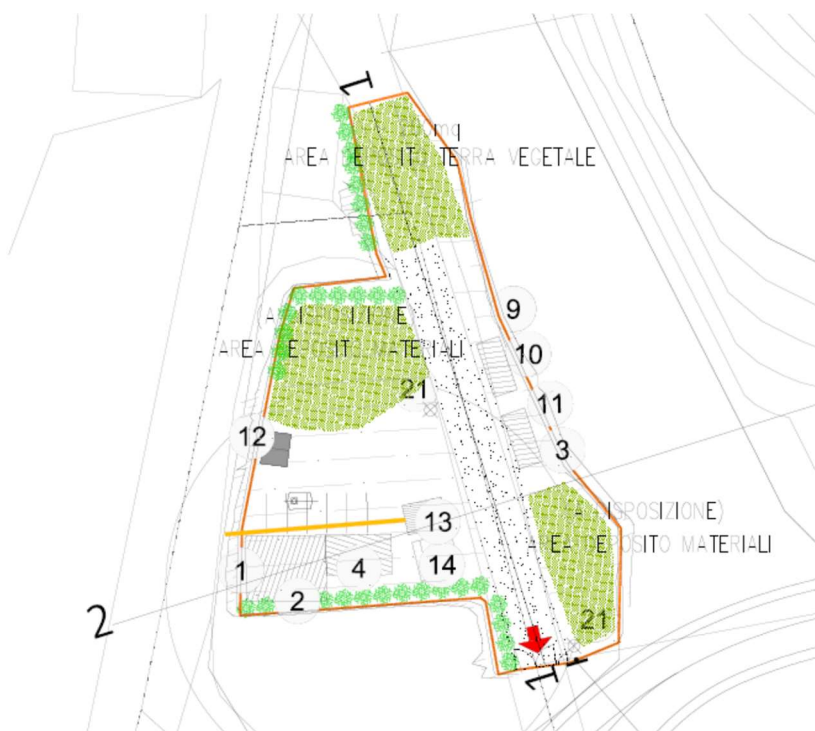
Figura 4: Rione Borgato: layout cantiere operativo
